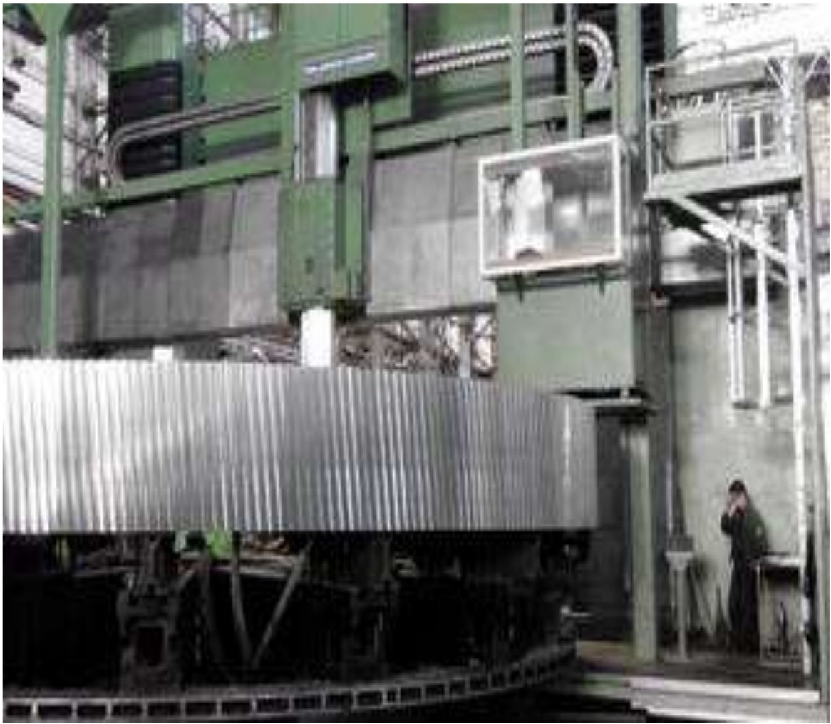
Рисунок 1.3– Обробка великомодульного зубчастого вінця на високоавтоматизованому обробному центрі «Waldrich Coburg – PowerTec» 7500
