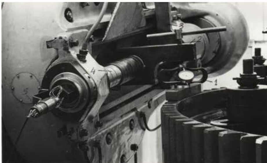
Рисунок 5.2 – Калібрування динамометричної оправки на верстаті мод.5А342
